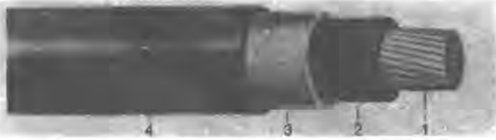
الشكل (9.1.a) كبل مصمت أحادي القلب مغلف بالبرصاص ومحمي بغلاف PVC
